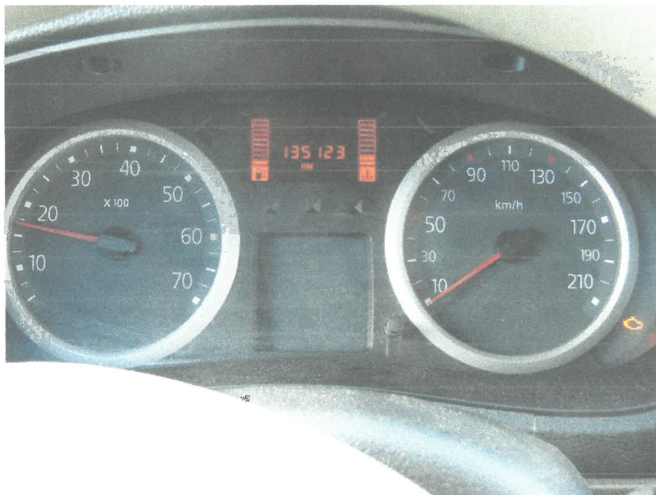
Fot. 5. Wskazania licznika 13523 km. Świecąca kontrolka „Check Engine” podczas pracy silnika.
